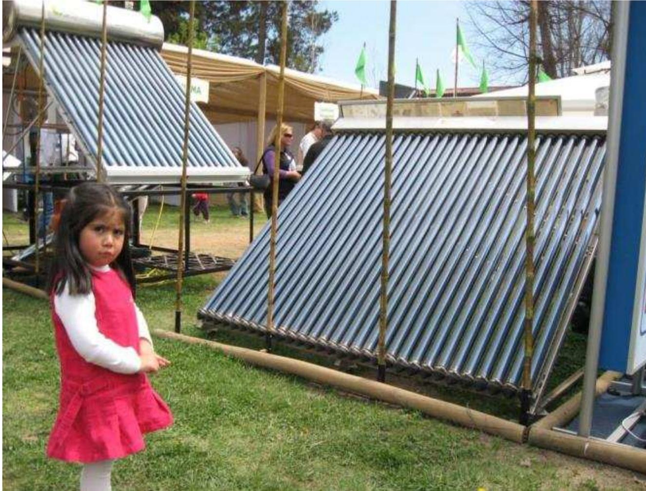
La imagen muestra un sistema Heat Pipe con acumulador y otro para sistema forzado
